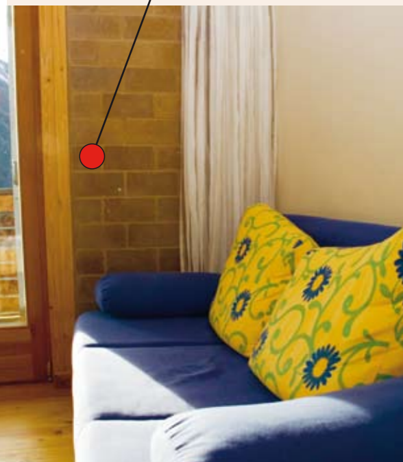
LEHMZIEGELWÄNDE: Südwände aus Lehm, der die Raumwärme natürlich reguliert
